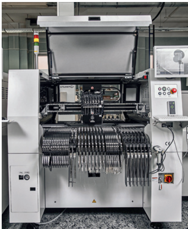
Высокоскоростной автомат установки компонентов
