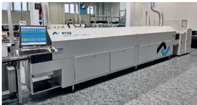
Конвекционная печь оплавления припоя для крупносерийного и массового производства
